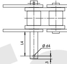
Bolzen mit Splintloch
