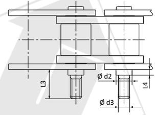
Gewindebolzen und/oder Abgesetzter Bolzen
