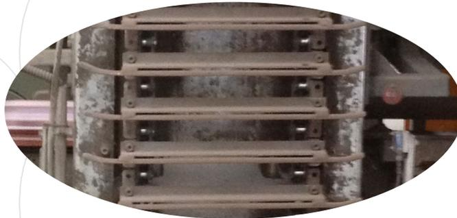
La combinación del tratamiento Delta® HR, que provee a las cadenas una alta resistencia al desgaste como abrasión más el emparejado han permitido obtener un desgaste más lento y constante de las cuatros cadenas con finalidad de multiplicar por dos su vida útil en comparación a las cadenas de la competencia previamente instaladas!!
